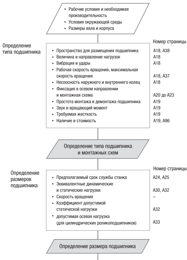
Рисунок 2.1. Схема подбора подшипников качения
