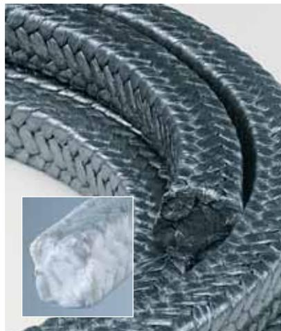
CHESTERTON 1760 является уникальным набивочным материалом, состоящим из PTFE-волокна с добавлением графитовых частиц. Готовый набивочный материал смазывается специальной силиконовой смазкой, обеспечивающей быструю приработку.
