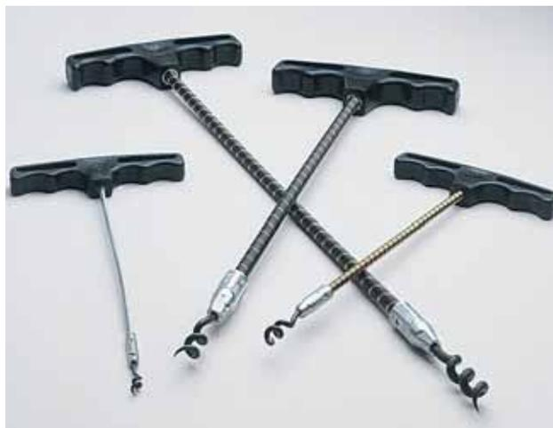
CHESTERTON 253 гибкие штопоры для извлечения сальниковых набивок: Имеют такие особенности конструкции, как высокое тяговое усилие, прецизионный закаленный штопор и стойкую к излому, выполненную на ротационно-ковочной машине ножку. Концевые части штопора имеют защитное пластиковое покрытие. Широкая, удобная рукоятка с гладкой поверхностью. Предлагаются в наборе из 4 инструментов.
