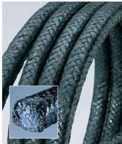
CHESTERTON 401 выполнен с применением армированной проволокой пряжи, которая оплетает гибкий и надежный сердечник, не содержащий асбеста. Уникальная конструкция набивочного шнура из пряжи в безасбестовой оболочке герметично охватывает армирующую проволоку в пряже, предотвращая износ и задиры поверхности штока. Эта уникальная конструкция делает 401 экономичным не уплотнением арматурного штока общего назначения для применения в условиях высоких температур и высоких давлений.
