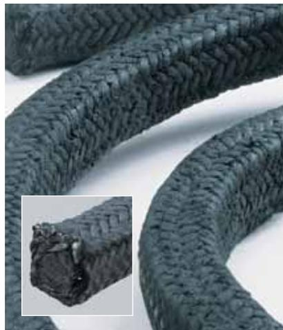
Уникальная угольно-графитная конструкция обеспечивает широкие возможности применения одной и той же катушки материала. CHESTERTON 370 выполнен из высококачественного углеволокна. Материал 370 содержит в себе частицы чистого графита, высокотемпературных масел и дисульфида молибдена, которые действуют как постоянные смазки и блокирующие добавки. Волокно с низким коэффициентом трения и способностью к работе при высоких температурах в оборудовании с неокислительной средой.
