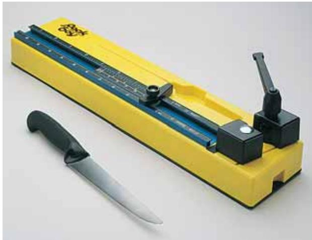
Нож CHESTERTON 178 позволяет аккуратно нарезать кольцами спиральные или плоские навитые уплотнения. Шкала считывает размеры в дюймах и миллиметрах непосредственно в пределах размеров вала. Чтобы выполнить работу, просто установите одну шкалу, чтобы совместить с размером поперечника сальниковых набивок, другую шкалу настройте на диаметр вала и отрежьте кольцо. Режет набивки размером от 1/8" (3 мм) до 1" (25 мм) для валов диаметром до 4" (100 мм).
